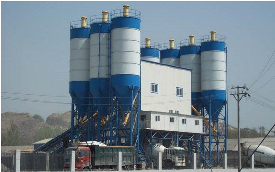
Рисунок 2.1 – Автоматичний бетонно-розчинний завод.
