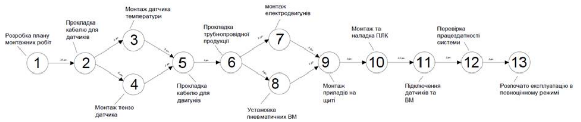
Рисунок 5.1– Сітковий графік монтажних робіт
