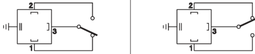
Рисунок 3.5 – Схема підключення роз'єму реле тиску ATOS
