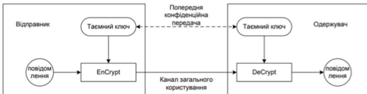
Рисунок 1.1 – Загальна схема передачі даних симетричного шифрування
