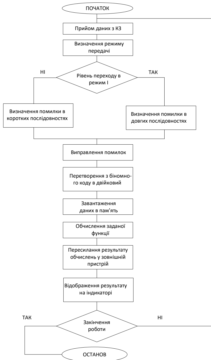
Рисунок 2.3 – Алгоритм роботи комбінаторного пристрою захисту даних на основі площинних кодів
