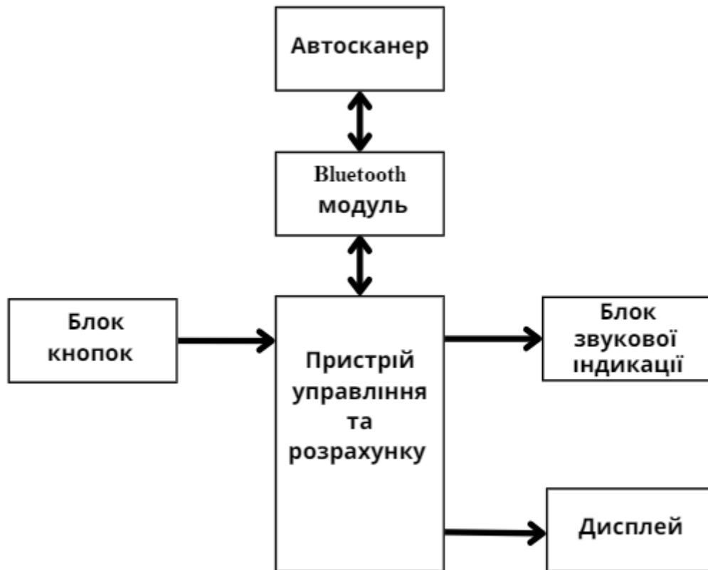
Рисунок 2.2 - Структурна схема бортового модуля контролю і управління автомобілем на основі Arduino
