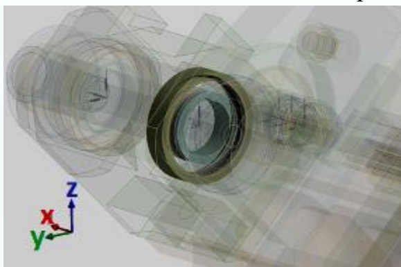
Рисунок 3.5 – Підшипник передньої бабки токарного верстата
