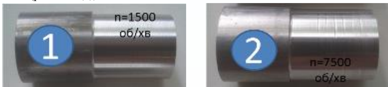
Рисунок 3.19 – Вплив поштовхів у системі на шорсткість обробленої поверхні (1 – 1 500 об/хв; 2 – 7 500 об/хв)
