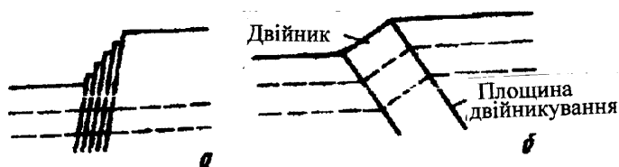
Рисуюнок 1.3 - Деформація ковзанням(а) і розтягом(б)
